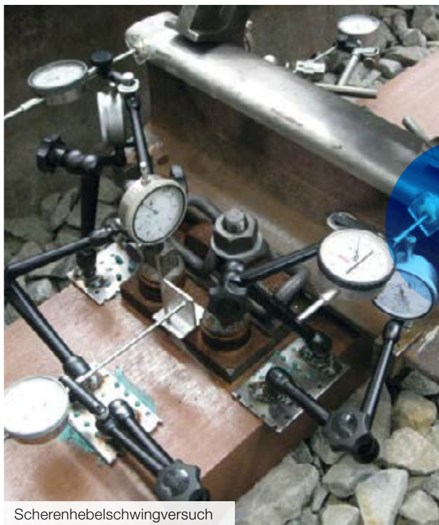
Ermüdungsprüfung unter dem Schienenaufleger
